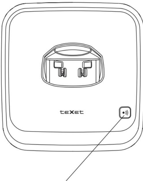
Кнопка поиска трубы, регистрации дополнительной трубы
