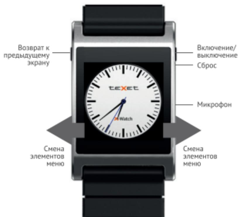
Для управления устройством и перемещения по элементам меню используйте касательные движения пальцев по экрану.
