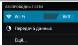
Для включения/выключения подключения к сети WiFi переместите переключатель вправо/влево. Более подробно процесс подключения к сети WiFi описан в разделе «Настройка WiFi и подключение к сети Интернет» (см. п. 9.3).
