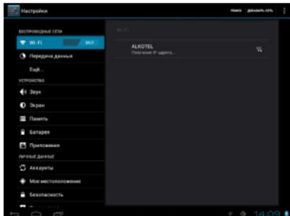
2. В разделе «Беспроводные сети» установите переключатель WiFi в положение «Вкл.». Устройство автоматически просканирует доступные сети WiFi.
