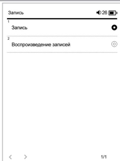
Для создания новой записи выберите **“Запись”** и нажмите кнопку **○**. Вы перейдете в режим записи файлов со встроенного микрофона.
