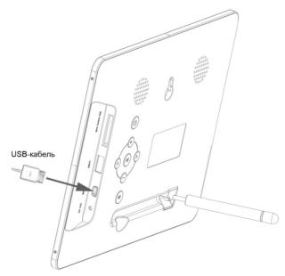
Подключите USB-кабель сначала в USB-разъем фоторамки, а затем в USB-порт компьютера. Включите питание фоторамки. На дисплее появится надпись "Соединение с ПК", фоторамка подключена к ПК.
